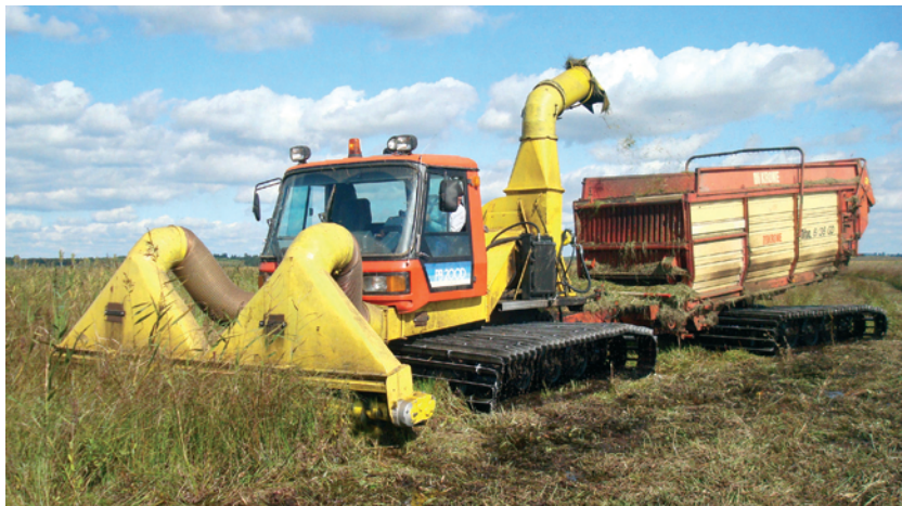
Рис.9: Крупномасштабное механизированное кошение низинных болот без повреждения почвенного слоя стало возможным благодаря использованию инновационных высокоэффективных машин на широких гусеницах. Такие машины оказывают незначительное давление на почву и обычно применяются для подготовки горнолыжных склонов (Бебжанский Национальный Парк, Польша, сентябрь 2009). Фото: Lars Lachmann.
