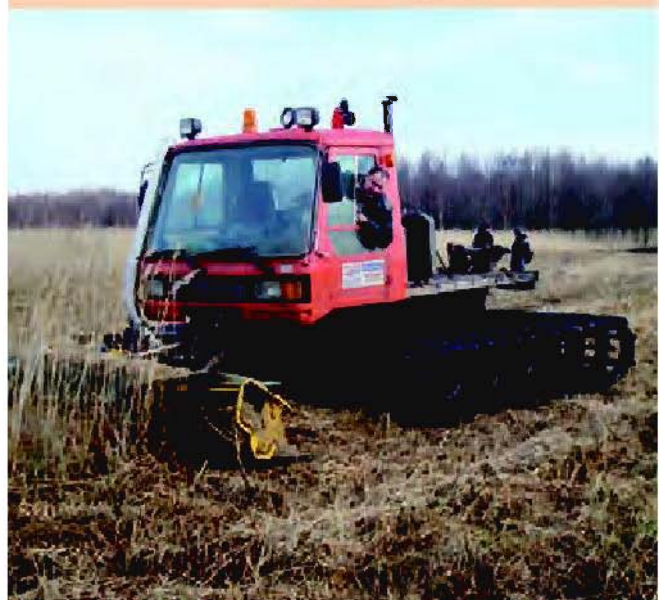
Seit 2007 gibt es an der Biebrza Maschinen, die in der Lage sind große Niedermoorflächen effektiv und schonend zu mähen. Die Technik beruht auf alpinen Pistenraupen.
