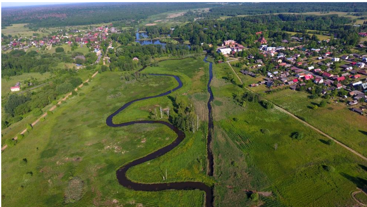
Odtworzone meandrowe koryto Narewki w Białowieży. Odtworzenie meandrów rzeki spowodowało znaczące, ponowne nawodnienie torfowiska wypełniającego dolinę. Archiwum Polskiego Towarzystwa Ochrony Ptaków
