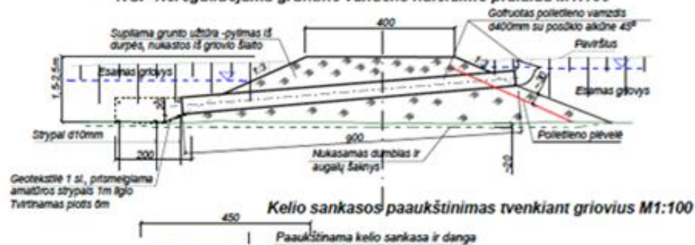
NGP Nereguliuojama gruntinė vandens nuleidimo pralaida M1:100
